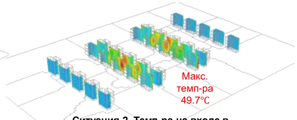
Ситуация 2. Темп-ра на входе в теплообменник
