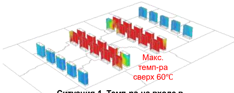
Ситуация 1. Темп-ра на входе в теплообменник
